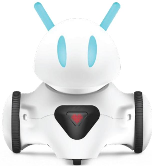
Para desplazarse, cuenta con dos motores de 200 rpm y está alimentado con una batería de 3.000 mAh que se recarga a través de USB y le proporciona una autonomía de entre cuatro y seis horas.
